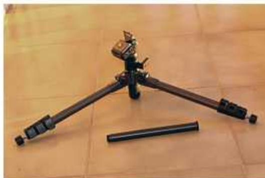
Figura 2. Trípode con patas de amplio ángulo de apertura
