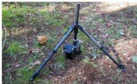
Figura 8. Trípode Slik con columna invertida
