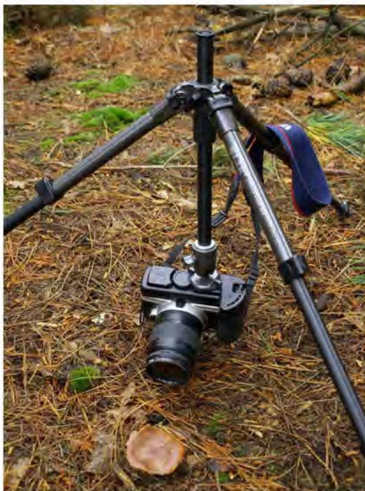
Figura 3. Trípode con columna invertida
