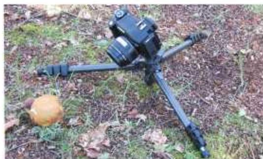
Figura 9. Trípode Slik patas con ángulo amplio
